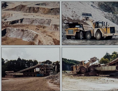
Abb. 7: Abbau auf verschiedenen Sohlen im Steinbruch Winterberg. Vor den Abbauwänden liegen mehrere tausend Tonnen sprangbarer, aufgelockerter Kalkstein (oben links). Das Hauwerk wird mittels Radlader auf Schwerlastkraftwagen geladen (oben rechts). Diese Fahrzeuge können pro Fahrt bis nahezu 100 t Gestein zur Brechanlage (unten links) am Rand des Steinbruchs transportieren. Die Aufgabe des Materials auf die Brechanlage erfolgt erneut durch Radladerbetrieb (unten rechts).
