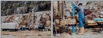
Abb. 6: Kernbohrprogramm 2010 im Steinbruch Winterberg-Iberg. Die abgeteuften Bohrungen sollen Aufschluss über die Ausbildung und die chemische Zusammensetzung des Kalksteins in mehr als 100 m Tiefe geben.
